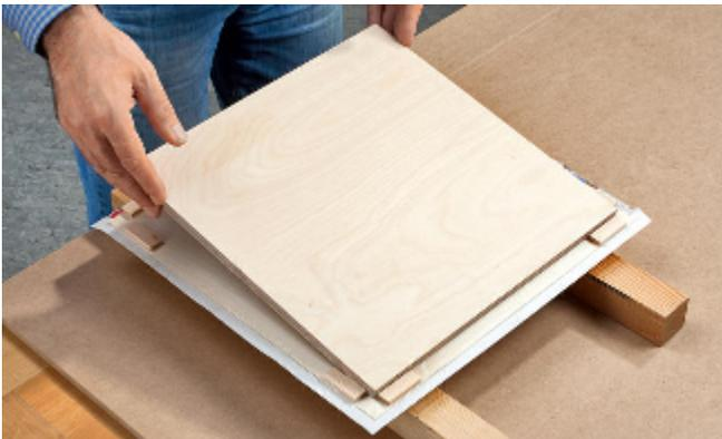
So auf die Rückseite des ersten Furnierblatts zwischen die Passhölzer platzieren. Darunter liegt eine Holzplatte mit Zeitungspapier.
