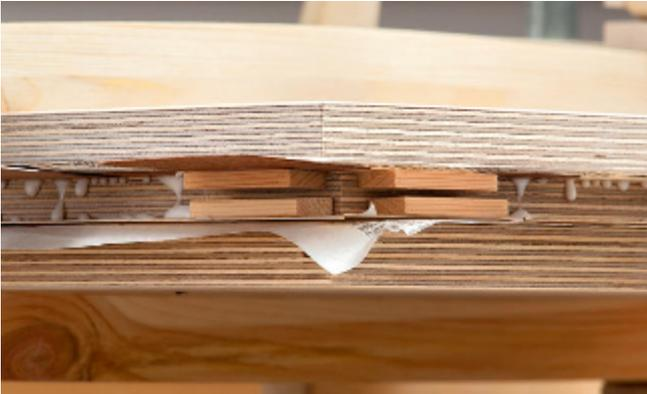
Mittig unterlegte und aufgespannte Querhölzer oben und unten sorgen für Anpressdruck in der Mitte. Bis zum Abbinden des Leims warten.
