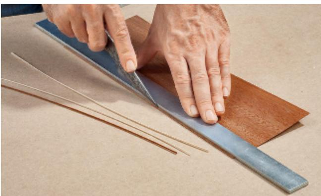
Anschließend wird zunächst eine Längsseite besäumt. Für alle Schnitte sollte ein scharfes Furniermesser verwendet werden.
