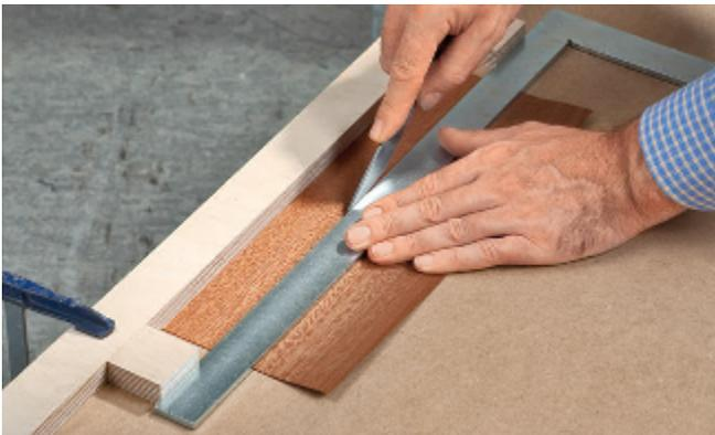
... gegen einen Anschlag legen und das Furnierblatt mit der besäumten Längskante gegen den Anschlag legen.
