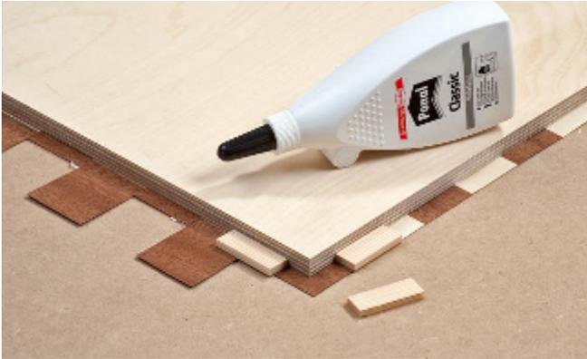
Die Trägerplatte (32 x 32 cm) genau auf der Furnierrückseite ausrichten und Passhölzer auf die Furnierecken leimen.
