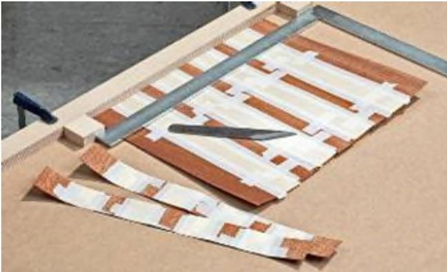
... und, wie bereits mit den einzelnen Furnierblättern gezeigt, zwei exakt 5 cm breite (ausen) und sechs exakt 4 cm breite Streifen (innen) entlang der Stahlschiene schneiden.
